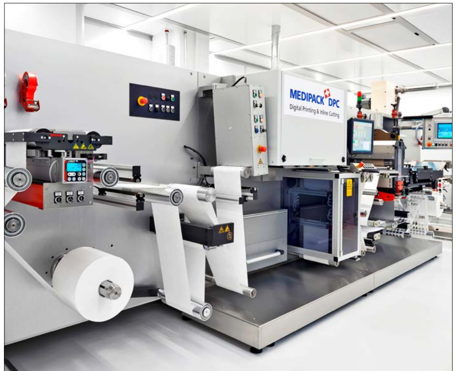
Der Digitaldruck wird in einem Reinraum CleanCell4.0 der Reinraumklasse ISO 8 durchgeführt. (Bilder: Medipack)
