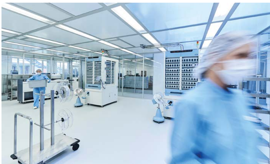
Verblisterungsmaschinen im Reinraum: Innerhalb von durchschnittlich 2,3 Sekunden werden Medikamente pro Patient und Einnahmezeitpunkt in perfekter Reihenfolge in einen Blister verpackt. (Bilder: Schweizer Blisterzentrum)
